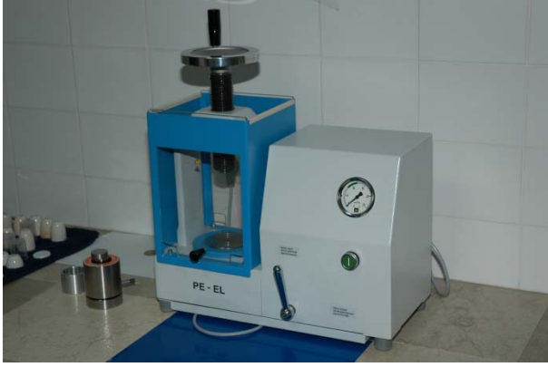
Fotoğraf 2 Toz Pellet hazırlama aparatı
