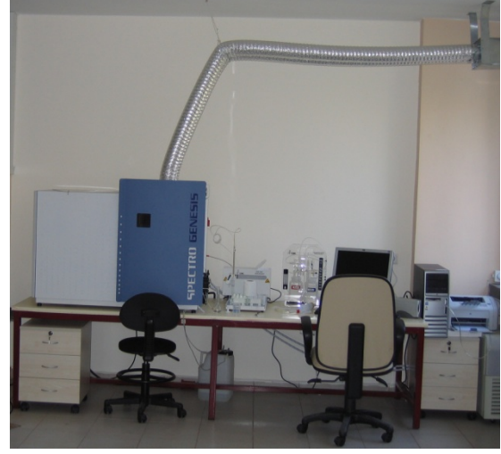
Fotoğraf 5 Ankara Üniversitesi Mühendislik Fakültesi Jeoloji Mühendisliği Bölümü Petrografi Uygulama ve Araştırma Laboratuvarındaki \mu XRF ve Mikro Analiz-ICP Laboratuvarındaki Atomik Emisyon Spektrometresi (ICP)
